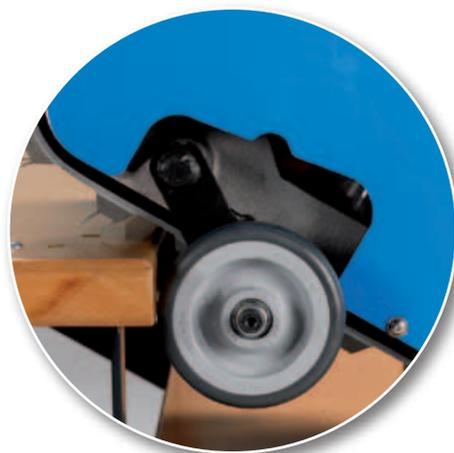
Las ruedas automáticas siempre activas que se adaptan automáticamente al estado vacío/llevo del peldaño y facilitan la traslación en posición horizontal
